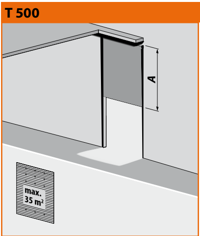
Système de rails vertical A= hauteur du jour + 560 mm, B= non applicable
